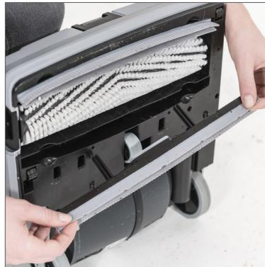
2. Contrôler la propreté et l'état d'usure des lamelles et de l'embouchure.
