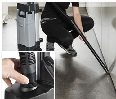
12. Pour utiliser le kit d'aspiration manuel, démarrer la machine en position verticale. Tourner le raccord sur «ON» et utiliser le tuyau d'aspiration. Lorsque le travail est terminé, positionner le raccord sur «OFF».
