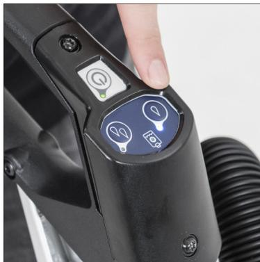
1. Vérifier que le bon paramètre de débit d'eau est bien sélectionné et que le réservoir de solution n'est pas vide.
