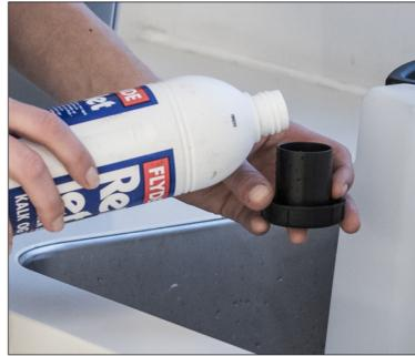
3. Bouchon doseur sur le réservoir permettant un dosage d'1% de détergent pour 3 Litres d'eau contenus dans le réservoir.
