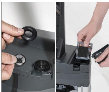
16. Vérifier et nettoyer les filtres de solution et d'aspiration régulièrement.
