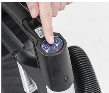
11. Le voyant rouge clignote si le niveau de solution est faible dans le réservoir et devient fixe si le réservoir est vide. Vider alors le réservoir de récupération et remplir le réservoir de solution pour continuer le nettoyage.
