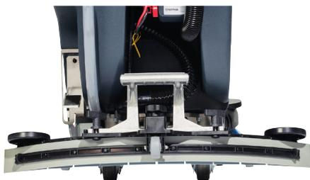
Système de lame à raclette breveté procure un entretien rapide et simple, les lames se retournant - quatre bords d'usure.
