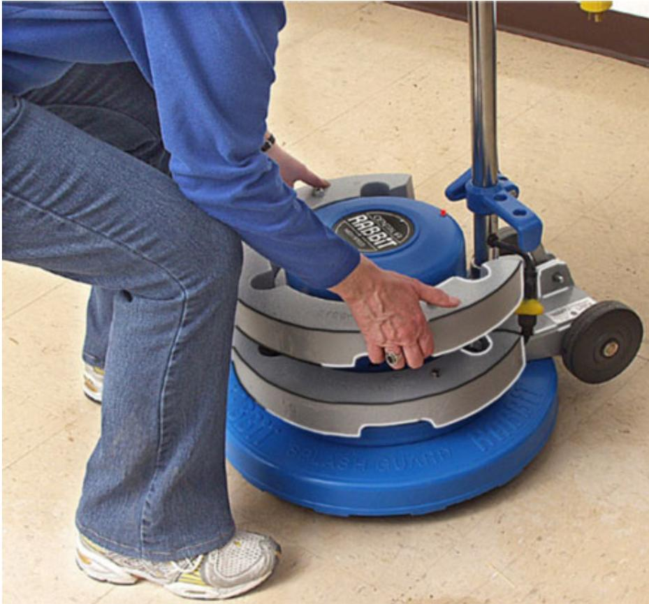
Abaisser la jupe anti éclaboussure et mettre les poids et vous avez la machine parfaite. Elle récurera ou décavera les planchers **RAPIDEMENT sans éclaboussures.**
