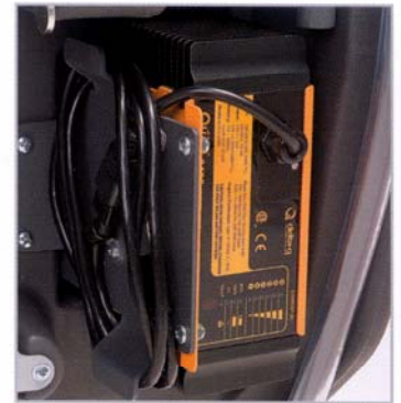
Le chargeur à bord de la machine est standard pour les batteries régulières ou gel.
