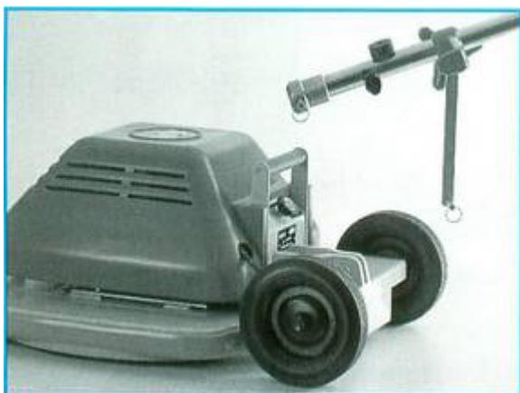
La base, la poignée et le câble du Swift sont des composants séparés. Ils peuvent être détachés pour faciliter le levage, le transport et le stockage.
